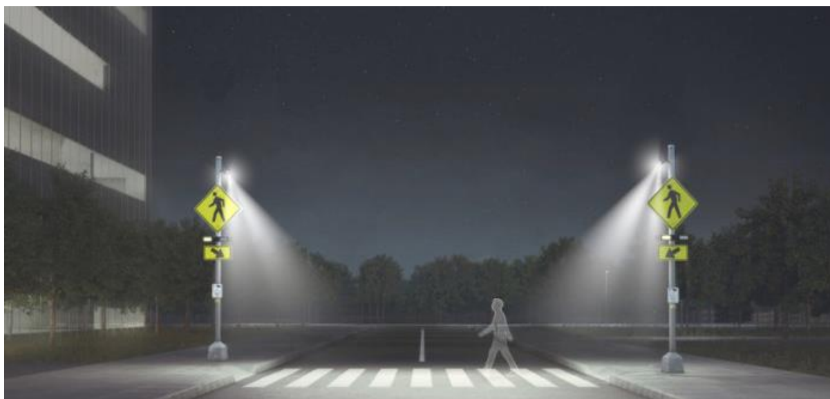
Rysunek 12 Rozsył światła odpowiedni dla oświetlenia przejścia dla pieszych
